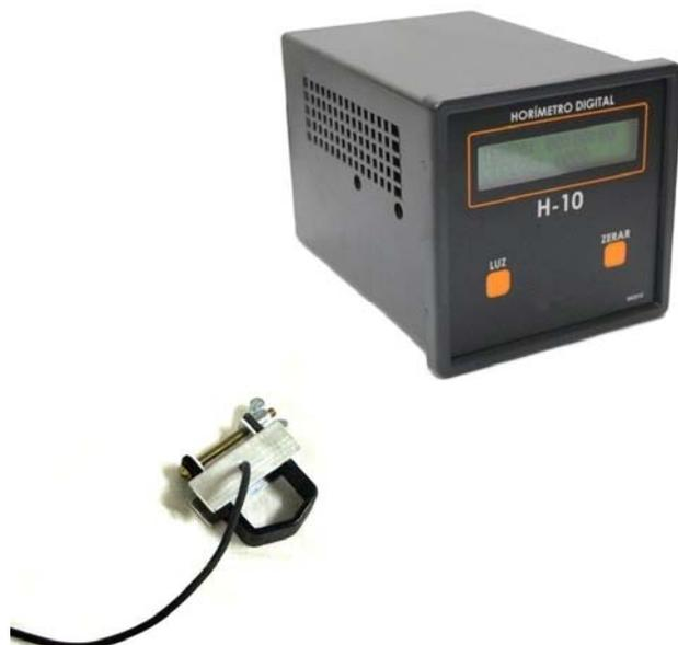
O horímetro digital portátil H-10 foi projetado para contar o tempo e o número de cordões de solda com corrente superior a 50A, tendo sido desenvolvido para o uso em equipamentos de corrente contínua (não identifica sinais AC).
