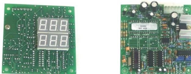
Possui displays de LED's de sete segmentos independentes para a corrente e para a tensão nas cores vermelho e verde respectivamente. O instrumento pode ser fornecido nas versões que mantém os últimos valores lidos permanentemente (hold) ou apenas durante 2 segundos após a extinção do arco.
