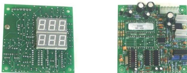
Possui displays de LED's de sete segmentos independentes para a corrente e para a tensão nas cores vermelho e verde respectivamente. O instrumento mantém os últimos valores lidos durante 2 segundos após a extinção do arco.
