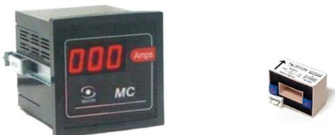
Possui display de LED's de sete segmentos para a indicação da corrente na cor vermelha. Para uma medida, com total isolamento galvânico, o mesmo utiliza um sensor de corrente por efeito hall.
