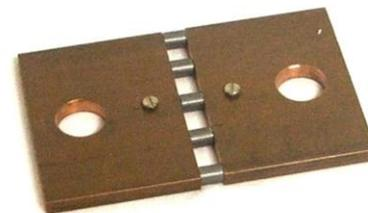
Conforme a figura acima,  $i_m$  é a corrente a ser medida e  $v_m$  é a tensão resultante sobre o shunt. A amplitude da tensão ( $v_m$ ) é definida pela relação do shunt e, dessa forma, um modelo, que possui, por exemplo, uma relação 2000A/150mV, produz sobre si uma tensão ( $v_{nom}$ ) de 150mV quando percorrido por uma corrente ( $i_{nom}$ ) 2000A.
