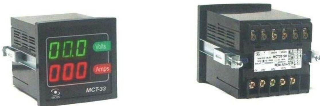
Possui displays de LED's de sete segmentos independentes para a corrente e para a tensão nas cores vermelho e verde respectivamente. O instrumento pode ser fornecido nas versões que mantém os últimos valores lidos permanentemente (hold) ou apenas durante 2 segundos após a extinção do arco.
