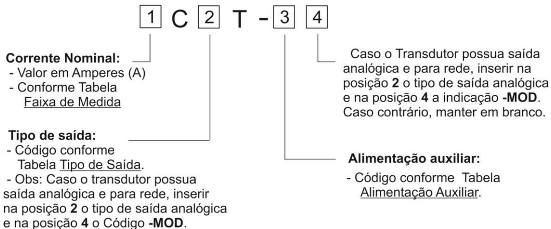
Utilizando o diagrama anterior, pode-se determinar o código dos produtos a partir da etiqueta fixada sobre o transdutor:
