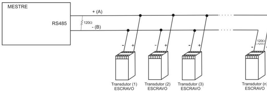
Deve ser evitada a existência de condutores não utilizados em redes físicas pois os mesmos poderão auto-ressonar e acoplar ruídos. Caso a alternativa não seja possível, utilizar resistores de terminação em ambas as extremidades (ver figura).
