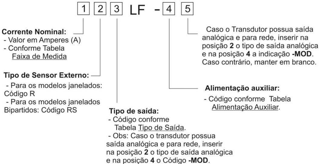
Utilizando o diagrama anterior, pode-se determinar o código dos produtos a partir da etiqueta fixada sobre o transdutor:
