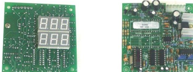
Possui displays de LED's de sete segmentos independentes para a corrente e para a tensão nas cores vermelho e verde respectivamente. O instrumento pode ser fornecido nas versões que mantêm os últimos valores lidos permanentemente (hold) ou apenas durante 2 segundos após a extinção do arco.
