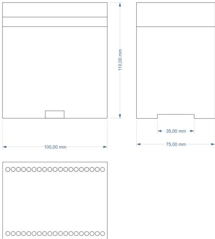
Encapsulamento padrão DIN de fixação em fundo de painel (trilhos 35mm).
