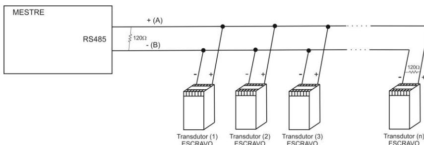
Deve ser evitada a existência de condutores não utilizados em redes físicas pois os mesmos poderão auto-resonar e acoplar ruídos. Caso a alternativa não seja possível, utilizar resistores de terminação em ambas as extremidades (ver figura).
