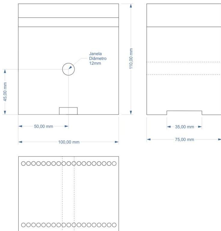
Encapsulamento padrão DIN de fixação em fundo de painel (trilhos 35mm).
