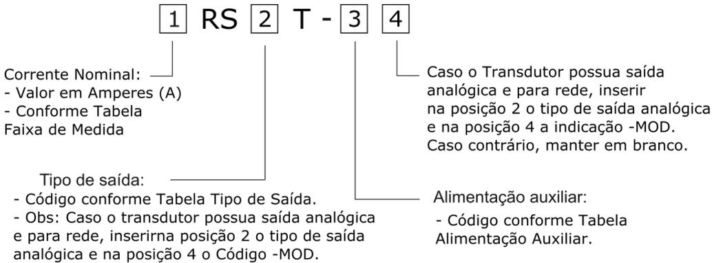
Utilizando o diagrama anterior, pode-se determinar o código dos produtos a partir da etiqueta fixada sobre o transdutor:
