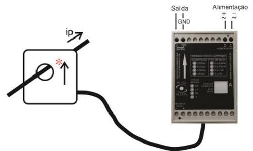
Obs: A conexão elétrica entre o sensor e o transdutor é através de cabo.
