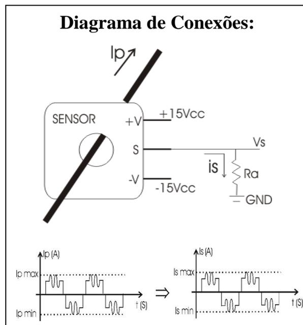
Obs: Grande parte do erro (80%) é devido ao erro de offset DC que pode ser desconsiderado em medidas AC desacopladas.
