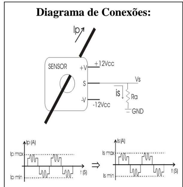
Obs: Grande parte do erro (80%) é devido ao erro de offset DC que pode ser desconsiderado em medidas AC desacopladas.
