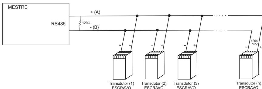
Deve ser evitada a existência de condutores não utilizados em redes físicas pois os mesmos poderão auto-ressonar e acoplar ruídos. Caso a alternativa não seja possível, utilizar resistores de terminação em ambas as extremidades (ver figura).
