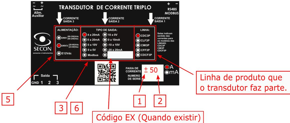
1 - Com o sinal  $\pm$ : indica que o transdutor possui medida bidirecional (DC com mudança de polaridade). Sem indicação, o transdutor possui medida unidirecional (DC sem mudança de polaridade).
