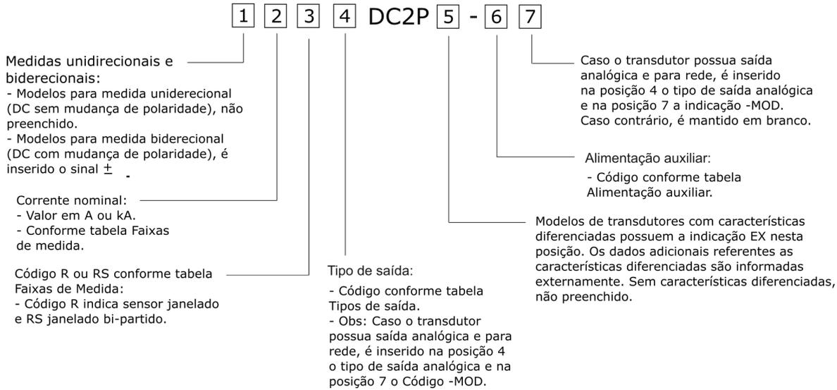
Utilizando o diagrama anterior, pode-se determinar o código dos produtos a partir da etiqueta fixada sobre o transdutor:
