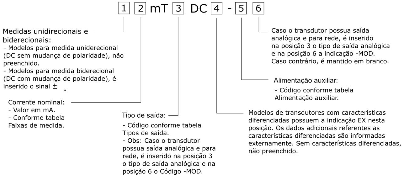
Utilizando o diagrama anterior, pode-se determinar o código dos produtos a partir da etiqueta fixada sobre o transdutor:
